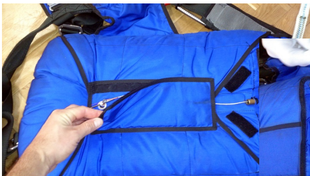
Öffnen der vorderen Abdeckung und Kontrolle der Manuellen-Auslöse-Pins
